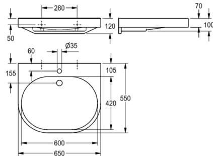
VARIUScare Einzelwaschtisch aus kunstharzgebundenem Mineralwerkstoff MIRANIT, Farbton Alpinweiß. Unterfahrbar, mit integriertem Griffband. Mit nahtlos eingeformter Mulde ohne Überlauf. Mit Armaturenbohrung. Befestigung an Beckenrückwand. Hintere Schwallkante, inklusive Befestigungsmaterial.
