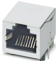
RJ45-Leiterplatten-Steckverbinder, Bauform: RJ45, Schutzart: IP20, Polzahl: 8, 10 GBit/s, Material: Metall, Anschlussart: THR-Reflow / THT-Welle
