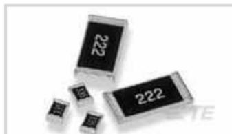
Widerstandstyp: **Leistungswiderstand**Anzahl der Anschlüsse: **2**Paketgrößencode: **1206**Verpackungsmethode: **Auf Bandware**Toleranz für passive Komponenten: **1 %**
