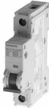
Leitungsschutzschalter 240V 14kA, 1-polig, D, 0,3A, T=70mm nach UL 489, gleiche Polarität
