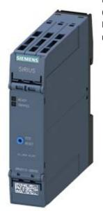
Thermistor-Motorschutzrelais Standard-Auswertegerät 22,5 mm Gehäuse Federzugklemme 2 Wechsler US = AC/DC 24 V-240 V Hand/Auto/Fern-RESET mit ATEX-Zulassung 2 LEDs (READY/TRIPPED) galvanische Trennung Test-/RESET-Taste Drahtbruchüberwachung Kurzschlussüberwachung nullspannungssicher
