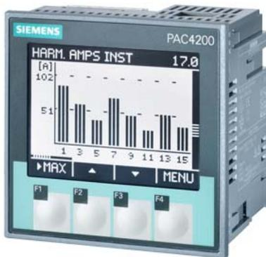
SENTRON, Messgerät, 7KM PAC4200, LCD, L-L: 500 V, L-N: 289 V, 5 A, 3-phasig, Modbus TCP, optional Modbus RTU / PROFINET / PROFIBUS / DI/DO, Schein- / Wirk- / Blindenergie / cos phi, Oberschwingungen: 2. - 64., THD, Klasse 0,2 gem. IEC61557-12 bzw. Klasse 0,2S gem. IEC62053-22, Kleinspannungsnetzteil, DC, Schraubanschluss
