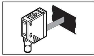
► Um stark reflektierende Materialien abzutasten, das Gerät um ca. 15° horizontal gegen die optische Achse neigen.
