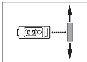
► Lichtfleck auf der zu erfassenden Farbfläche positionieren.
