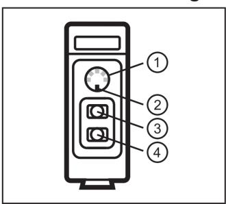
1: 5 LEDs grün Toleranzstufen
