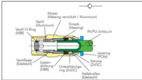
**Werkstoffe:** Körper: Messing vernickelt/PBT/Aluminium, Ventil: Aluminium, Dichtung: NBR, Haltekrallen: Edelstahl, Patrone: ZnDC vernickelt, Lösering: PBT (bei der Montage werden ausschließlich silikonfreie Dichtungen und Schmierstoffe verwendet)
