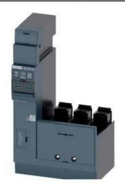
RCD- MODULE RCD510 BASIC RCD TYPE A SIDE MOUNTED ADJUSTABLE 0,03...5A AT 50/60HZ ADJUSTABLE TV 0...1000MSEC 3- POLE IN=160A UE=127-480V ACCESSORY FOR: 3VA1 WITH CABLE LUG
