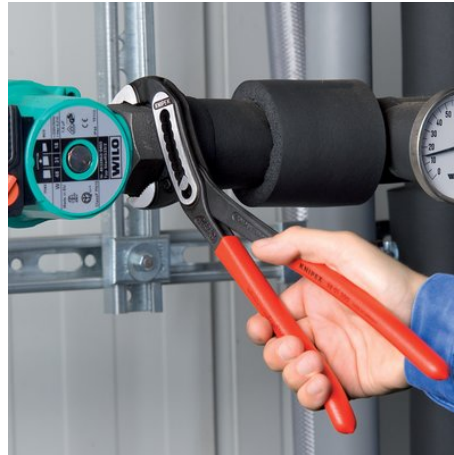
Autoblocante en tuberías y tuercas: agarre perfecto en la pieza de trabajo; toda la fuerza realizada se centra en el trabajo sobre la pieza. Se disminuye la fuerza requerida.
