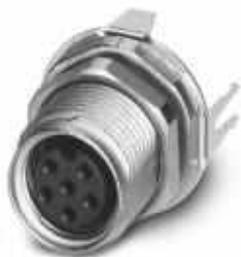
Sensor-/Aktor-Einbausteckverbinder, Buchse, 6-polig, M8, Hinterwand-/Schraubmontage mit M10-Befestigungsgewinde, mit geradem Lötanschluss
