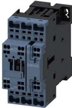
Leistungsschütz, AC-3 25 A, 11 kW / 400 V 1 S + 1 Ö, DC 24 V
