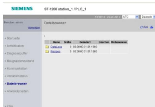
Auf der Dateibrowser-Seite können Sie Dateien im Ladespeicher der CPU wie z. B. Datenprotokolle (Seite 126) und Rezepte anzeigen, herunterladen oder bearbeiten. Sofern die CPU nicht mit Schutzstufe 4 geschützt ist, können alle Anwender die Dateien auf der Dateibrowser-Seite anzeigen. Anwender mit Rechten zum Ändern von Dateien können Dateien löschen, bearbeiten und umbenennen.
