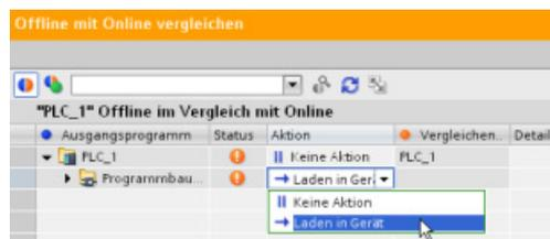
Klicken Sie in die Spalte "Aktion" eines Objekts, um auszuwählen, ob das Objekt gelöscht, keine Maßnahme durchgeführt oder das Objekt in das Gerät geladen werden soll.
