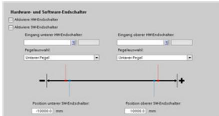
Konfigurieren Sie die Eigenschaften für die Antriebssignale, Antriebsmechanik und Positionsüberwachung (Hardware- und Software-Endschalter).
