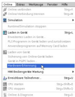
Nach dem Anlegen der nicht spezifizierten CPU können Sie die Hardwarekonfiguration von der Online-CPU laden.
