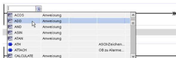
1. Öffnen Sie die Klappliste mit Anweisungen, indem Sie auf die gelbe Ecke der "Box"-Anweisung klicken.
