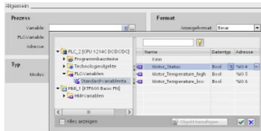
Sie können PLC-Variablen auch mit der Maus aus der Projektnavigation in das HMI-Bild ziehen. Rufen Sie die PLC-Variablen in der Ansicht "Details" in der Projektnavigation auf und ziehen Sie die Variable dann mit der Maus in das HMI-Bild.
