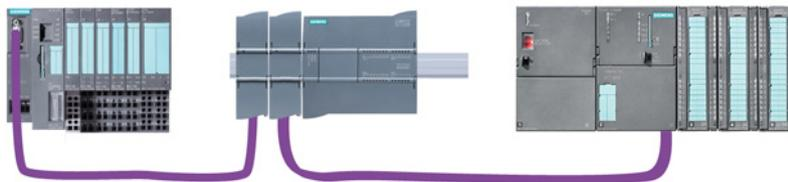
In V4.0 können Sie maximal drei PROFIBUS-CMs je Station konfigurieren, wobei es sich um eine beliebige Kombination aus DP-Master- oder DP-Slave-CMs handeln kann. DP-Master in einer Implementierung mit einer CPU ab Firmware-Version 3.0 können jeweils maximal 32 Slaves steuern.
