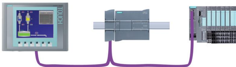
Wenn ein CM 1242-5 und ein CM 1243-5 zusammen installiert sind, kann eine S7-1200 gleichzeitig sowohl als Slave eines übergeordneten DP-Mastersystems als auch als Master eines untergeordneten DP-Slavesystems fungieren.
