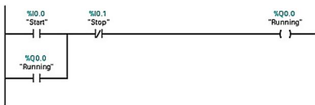
Kontakte dienen zum Testen des Binärstatus des Bits. Ergebnis dieses Tests ist entweder "Signalfluss" bei Ein (1) oder "kein Signalfluss" bei Aus (0).
