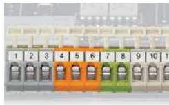
Gruppenbildung durch farbige Isoliergehäuse
