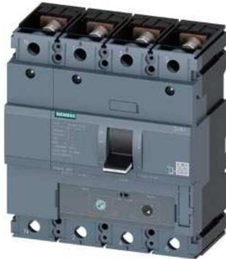
Leistungsschalter 3VA1 IEC Frame 250 Schaltvermögenklasse H Icu=70kA @ 415V 4-polig, Anlagenschutz TM240, ATAM, In=250A Überlastschutz Ir=175A...250A Kurzschlusschutz Ii=5...10 x In N-Leiter ungeschützt Schraubenflanschanschluss
