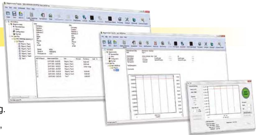
Die **Software DataView®** mit ihrem Modul **Megohmmeter Transfer** erkennt automatisch das an den PC angeschlossene Gerät und startet das entsprechende Bedien-Menü. Die übersichtliche Baumstruktur des Menüs ermöglicht dem Benutzer den direkten Zugriff auf die im Gerät gespeicherten Daten oder die Konfiguration des Prüfers. Weitere Funktionen sind:
