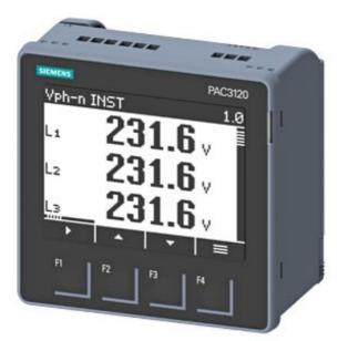
SENTRON PAC3120 LCD 96X96 mm Power Monitoring Device Schalttafeleinbaugerät zur Messung elektrischer Größen Protokoll: Modbus RTU Mit grafischem Display UE Nenn: 690/400V 45-65Hz IE Nenn: X/1A oder X/5A AC Hilfsenergie: 100 ... 250 V +-10 % AC/DC Schraubklemmenanschluss
