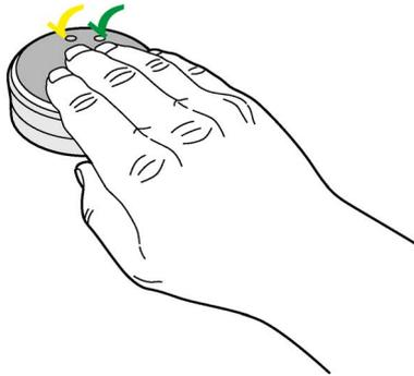
Der Kontakt bleibt so lange geschlossen, wie der Sensortaster berührt wird. Für die Betätigung ist keine Kraft notwendig.
