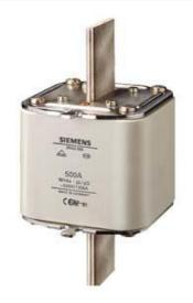
NH-SICHERUNGSEINSATZ GL/GG +SPANNUNGSFUEHREND.GRIFFLASCHEN MIT STIRNKENNMELDER GR.4A, 1000A, AC 500V/DC 440V
