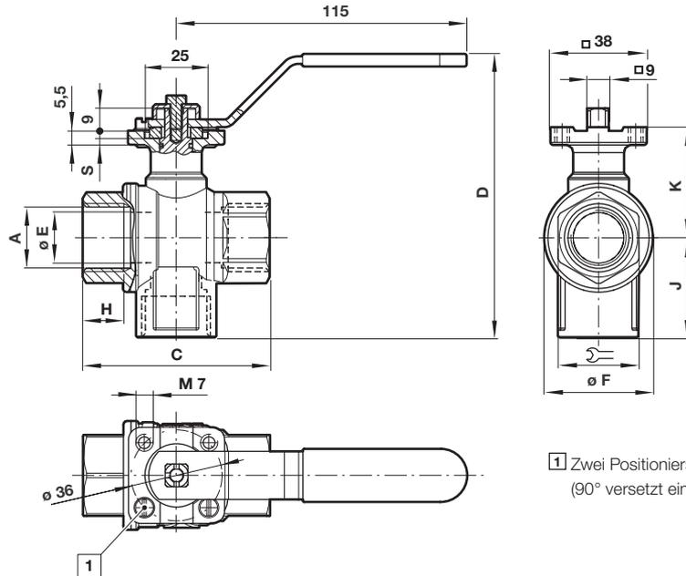
1 Zwei Positionierstifte für Endanschlag (90° versetzt einsetzbar)
