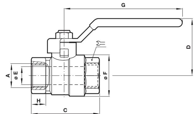
**Voller Durchfluss, Innengewinde/Innengewinde**
