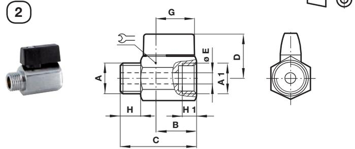
**erter Durchfluss, Innengewinde/Innengewinde**
