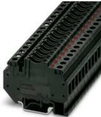
Flachsicherungsklemme, Querschnitt: 0,2-6 mm<sup>2</sup>, AWG: 26-8, Breite: 8,2 mm, Farbe: schwarz, mit Leuchtanzeige, Spannung Leuchtanzeige: 12 V DC, Strom Leuchtanzeige: 2 mA
