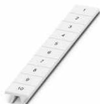
Zackband, Streifen, weiß, beschriftet, beschriftbar mit: CMS-P1-PLOTTER, quer bedruckt: fortlaufende Zahlen 1 ... 10, 11 ... 20 usw. bis 91 ... 100, Montageart: verrasten, für Klemmenbreite: 8,2 mm, Schriftfeldgröße: 10,5 x 8,15 mm, Anzahl der Einzelschilder: 10
