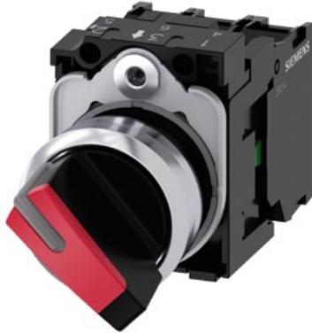
Knebelschalter, beleuchtet, 22 mm, rund, Metall, hochglanz, rot, Knebel, kurz, 2 Schaltstellungen O-I, verrastend, Schaltwinkel 90°, 10:30h/13:30h, mit Halter, 1S, 1Ö, LED rot, AC/DC 24V, Schraubanschluss
