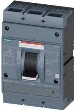
Leistungsschalter 3VA5 UL Frame 800 Schaltvermögenklasse M 35kA @ 480 V 3-polig, Anlagenschutz TM230, FTAM, In=800A Überlastschutz Ir=800A fest eingestellt Kurzschlusschutz Ii=5...10 x In Schraubenflächanschluss
