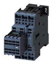
Leistungsschütz, AC-3 25 A, 11 kW / 400 V 2 S + 2 Ö, DC 110 V 3-polig, Baugröße S0 Federzuganschluss Hilfsschalter lösbar
