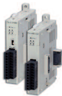
Sondermodule steigern die Leistung beim Positionieren
