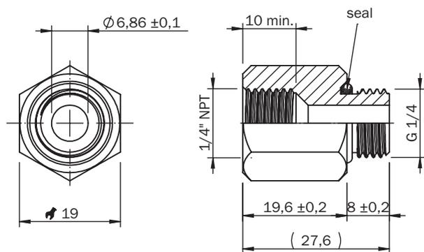
Unterseite: ¼" NPT-Innengewinde, vormontierter NPT-Adapter in G ¼-Innengewinde, Rückseite: G ¼-Innengewinde
