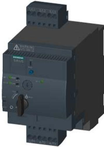
SIRIUS, KOMPAKTABZWEIG, WENDESTARTER 690 V, AC/DC 24 V, 50 ... 60 HZ, 0,1 ... 0,4 A, IP20, ANSCHLUSS HAUPTSTROMKREIS: FEDERZUGANSCHLUSS, ANSCHLUSS STEUERSTROMKREIS: STECKBAR, OHNE KLEMMEN
