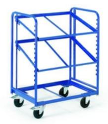
Winkelstahl (40/40/4 mm), Rahmen der Etagenböden aus Winkelstahl (30/30/3 mm). Pulverbeschichtung in Enzianblau (RAL5010). Die Fixierung der Einlegeböden ist in Abständen von 50 mm möglich. Über eine Flügelmutter lassen sich die Böden stufenlos bis 20-Grad neigen. Der überstehende Rand ist je nach Ausführung 15 mm (mit Holzboden) oder 25 mm (offener Rahmen). Im Lieferumfang sind zwei Einlegeböden und ein Grundboden enthalten. Die Tragkraft pro Einlegeboden beträgt max. 60 kg.
