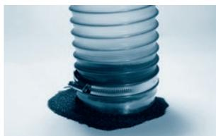
Deutliche Leckage bei Verwendung herkömmlicher Schlauchschellen.
