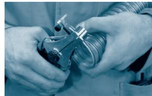
...oder komfortabel mit einer speziellen Abisolierzange entfernen.
