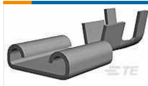
TE Teilnr.:2-160304-4 250 FASTON,REC.,14-17AWG,PNIPST
