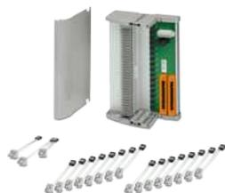
Termination Carrier zur redundanten Anbindung von 16 MACX Analog Ex i NAMUR-Trennverstärkern an digitale Eingangskarten der Yokogawa ProSafe-RS Steuerung, über zwei KS50-Steckverbinder, 50-polig. Geeignet für die Yokogawa-Karte SDV144.
