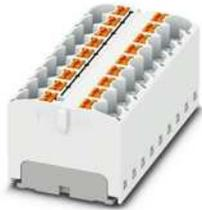
Verteilerblock, die Blöcke sind untereinander über den Leiterschacht brückbar, passende Steckbrücken siehe Zubehör, intern gebrückt, Nennspannung: 450 V, Nennstrom: 32 A, Anschlussart: Push-in-Anschluss, Querschnitt: 0,2 mm<sup>2</sup> - 6 mm<sup>2</sup>, Montageart: aufrasten auf Tragschienenadapter, Direktmontage mit Flansch, Fliegend, Farbe: weiß
