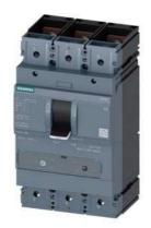
Leistungsschalter 3VA1 IEC Frame 400 Schaltvermögenklasse S Icu=36kA @ 415V 3-polig, Anlagenschutz TM240, ATAM, In=320A Überlastschutz Ir=224A...320A Kurzschlussschutz Ii=5...10 x In Schraubenflachanschluss Leistungsschalter 3VA1 IEC Frame 400 Schaltvermögenklasse S Icu=36kA @ 415V SPANNUNGSAUSLOESER LINKS 208-277 V AC 50/60 HZ 1 HILFSSCHALTER HP 1 AUSGELOEST-MELDESCHALTER HP
