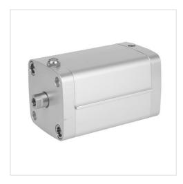
ISO 21287 Normen Druckluftanschluss Innengewinde Betriebsdruck min./max. 1 ... 10 bar Umgebungstemperatur min./max. -20 ... 80 °C -20 ... 80 °C Mediumstemperatur min./max. Medium Druckluft Max. Partikelgröße 50 µm Ölgehalt der Druckluft 0 mg/m<sup>3</sup> Druck zur Bestimmung der Kolbenkräfte 6.3 bar
