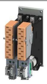
SCHUETZ BAUGROESSE 12, 2POLIG, DC-3 UND 5, 400A HILFSSCHALTER 4NO+4NC DC-BETAETIGUNG DC 220V
