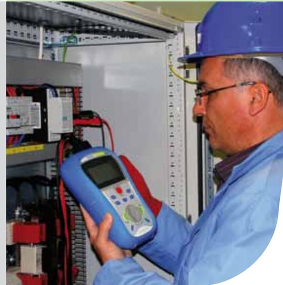
**Das MI 3242 MicroOhm 2A ist ein tragbares Widerstandsmessgerät zum Messen der geringen Widerstände von Schaltern, Relais, Verbindern, Sammelschienen, Kabelverbindungen von Stromverteilern, Motor- und Generatorwicklungen, Netztransformatoren, Speicherdrosseln, Gleisverbindern, Drähten und Kabeln, Schweißverbindungen für industrielle Anwendung usw. mit Prüfströmen bis 2 A.**
