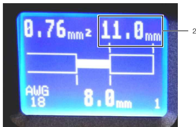
Obr. 4: Délka odizolování na displeji
