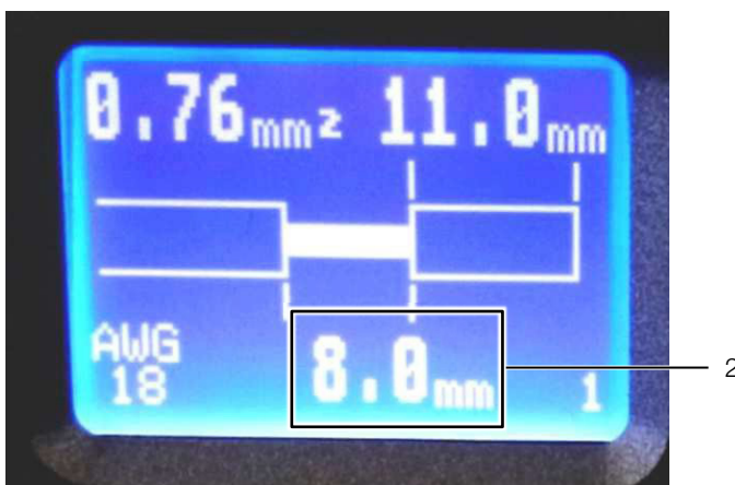
Obr. 6: Délka odtažení izolace na displeji
