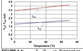
**FIGURE 4-4:**  $T_{ON}/T_{OFF}$  vs. Temperature.
