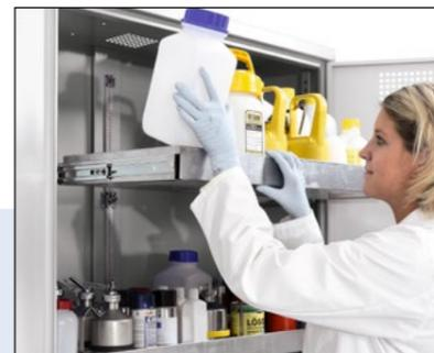
Ist eine Auffangwanne ausgezogen, werden die übrigen automatisch an der Rückwand arretiert. So wird verhindert, dass der Schrank vorderlastig wird. Zusätzlich empfehlen wir, den Schrank mit dem mitgelieferten Befestigungsset an einer Wand zu fixieren. Die ausgezogenen Wannen erleichtern Ihren Zugriff auf die eingelagerte Ware.
