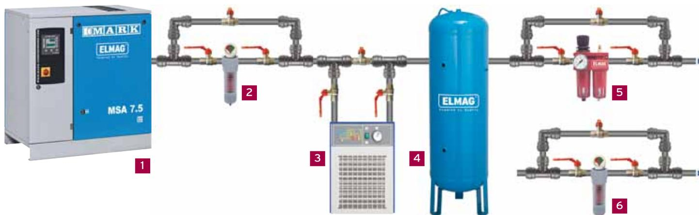
Schematisches Beispiel für die Komponenten-Bauweise einer Druckluft-Versorgungsanlage mit Schraubenkompressor 1, Vorfilter 2, Kältetrockner 3 und Speicherbehälter 4.
