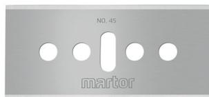
Die INDUSTRIEKLINGE NR. 45 von MARTOR ist eine hochwertige Klinge aus Stahl. Sie ist sehr scharf und verfügt über vier nacheinander nutzbare Schneidkanten für eine besonders lange Einsatzzeit. Die Klinge ist 39,0 mm lang, 18,5 mm breit und 0,30 mm stark.
