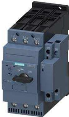
Leistungsschalter Baugröße S2 für den Motorschutz, CLASS 10 mit Überlast-Relaisfunktion A-Auslöser 70...80 A N-Auslöser 1040 A Schraubanschluss Standardschaltvermögen
