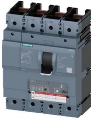
Leistungsschalter 3VA6 UL Frame 600 Schaltvermögenklasse H 65kA @ 480V 4-polig, Anlagenschutz ETU320, LI, In=400A Überlastschutz Ir=160A...400A Kurzschlusschutz Ii=1,5...12 x In N-Leiterschutz einstellbar (OFF, 50%, 100%) ohne Anschluss
