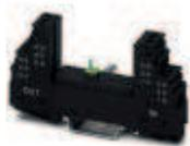
Elemento base per la spina di protezione PT con circuito di protezione per due circuiti di segnale a due conduttori a potenziale di terra zero, scaricatore a gas tra i collegamenti 3-4 (GND) e 9-10, montaggio su NS 35/7,5 e NS 35/15, spessore custodia: 17,5 mm
