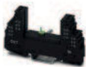
Elemento base per la spina di protezione PT con circuito di protezione per due circuiti di segnale a due conduttori a potenziale di terra zero, ponticello tra i collegamenti 3-4 (GND) e 9-10, montaggio su NS 35/7,5 e NS 35/15, spessore custodia: 17,5 mm
