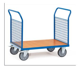
Stahlrohr und Profilstahl geschweißt, pulverbeschichtet RAL 5007, Plattform Holzwerkstoffplatte, Oberfläche Buchendekor. 2 Stirnwände aus Drahtgitter 50 x 50 x 4 mm, Wände 500 mm hoch. 2 Lenk- und 2 Bockrollen, TPE-Bereifung 200 x 40 mm, Naben mit Rillenkugellager. Feststeller an den Lenkrollen, gemäß der Europäischen Norm EN 1757-3 (Sicherheit von Plattformwagen).
