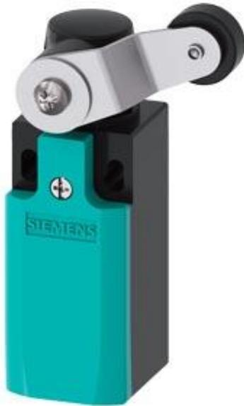
Positionsschalter Kunststoffgehäuse nach DIN EN 50047, 31 mm, Geräteanschluss 1 x (M20 x 1,5) 1S/2Ö Sprungkontakte, Schwenkhebel, 35 mm lang rechts/links einstellbar, mit Kunststoffrolle 19 mm, kundenspezifisch: Schwenkhebel auf Umschlag (180 Grad gedreht) montiert und im Uhrzeigersinn unter einem Winkel: 70° fixiert
