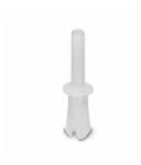
Kunststoff-Spreizniet, für Bohrlochdurchmesser 4 mm und eine Materialstärke von 1,5... 6 mm
