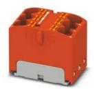
Verteilerblock, die Blöcke sind untereinander über den Leiterschacht brückbar, passende Steckbrücken siehe Zubehör, intern gebrückt, Nennspannung: 450 V, Nennstrom: 32 A, Anschlussart: Push-in-Anschluss, Querschnitt: 0,2 mm² - 6 mm², Montageart: aufrasten auf Tragschienenadapter, Direktmontage mit Flansch, Fliegend, Farbe: rot
