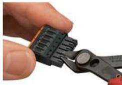
Kodieren einer Federleiste durch das Abtrennen der Kodiernase
