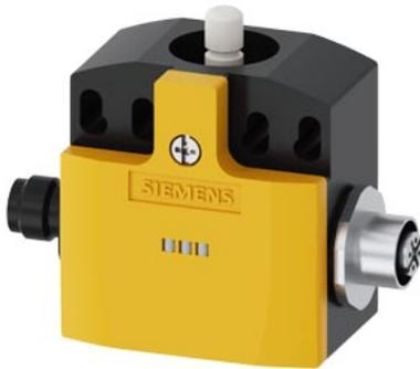
Basisschalter ohne Antriebskopf Kunststoffgehäuse 50 mm breit ASIsafe integriert AS-i Status: 1:F-IN1, 2:F-IN2 3:AS-i/FAULT Schleichschaltglieder 2Ö mit M12-Stecker 4-polig Kanal 1 an Ö, Kanal 2 an M12-Buchse rechts
